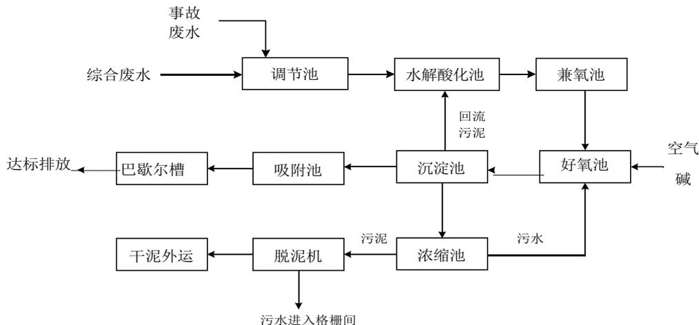
图 3.2.3-1 现有工程废水处理工艺流程图
